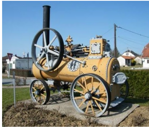
Locomobile Salmson n° 3003, construite en 1900. Sa pression d'utilisation était de 7 bars. Propriété de la Compagnie des Chemins de fer du Nord, elle servait à entraîner les machines outils des Ateliers d'Hellemes (Nord).
